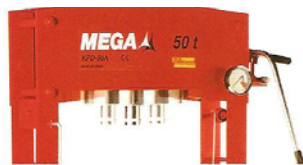
posúvací valec pozdĺž hlavy lisu na modeloch KPD
