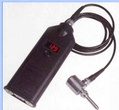
Vibračný merací prístroj
